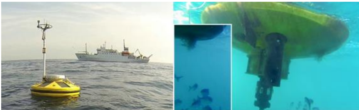
Рис. 3.7.2. Гидрометеорологический измерительный буй-волнограф, установленный в шельфовой зоне залива Петра Великого, стая рыб японских гипероглифов ( Hyperoglyphe japonica ) под бумом в момент съёмки.
