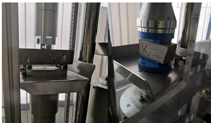
Рис. 3.3.1. Испытание прочностных характеристик опытных образцов цементных смесей в лаборатории строительных материалов ДВФУ
