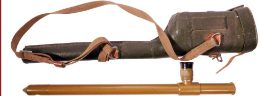
Перископ разведчика окопный оптический (с чехлом). РСФСР, 1941 г. Принадлежал генерал-полковнику В. Д. Цветаеву.
